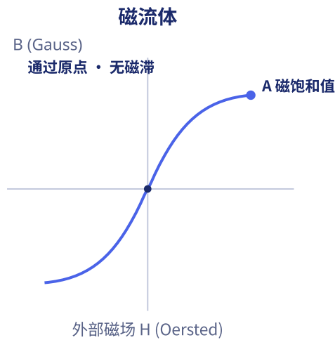
磁化曲线（B-H 曲线）对比 —— 普通磁性体会画出宽阔的磁滞回线，而磁流体只画出一条通过原点的 S 形曲线
